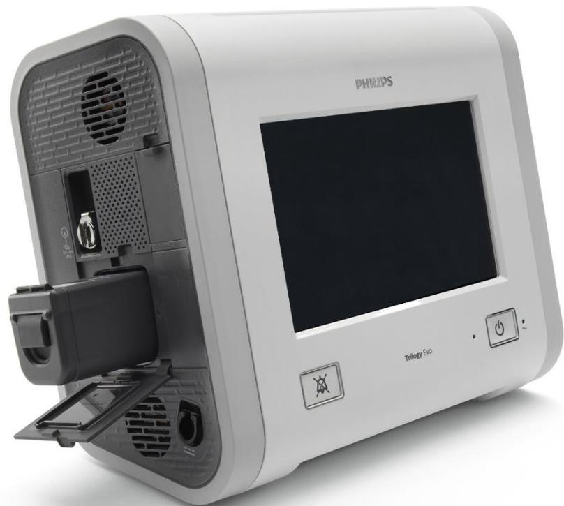
\*Tiempo de duración nominal por método según la Comisión Electrotécnica Internacional (7,5 h/batería). Tiempo de carga de la batería desmontable de 0 % a 80 % de 2,5 horas, tiempo de carga de la batería interna de 0 % a 100 % de 3,5 horas. Circuito con Modo A/C-VC con PAP activa, PEEP 3 cmH<sub>2</sub>O y Vt 800 ml.
